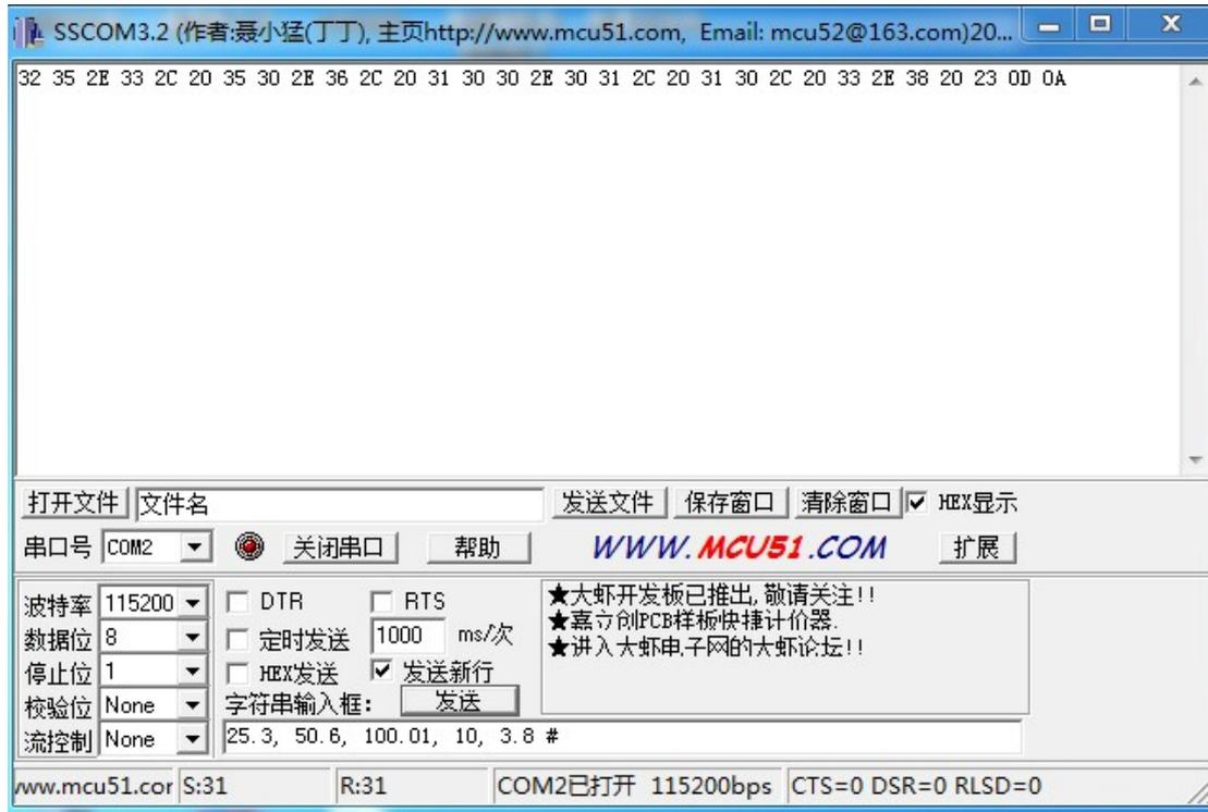
现在我以串口来模拟传感器来写这个程序. 温度: 25.3 , 湿度: 50.6, 气压 100.01, 雨量:10 , 风速:3.8 , # 换行结束标志. 用一根 USB 转 232 线. 把 2,3 脚短接. 打开串口调试软件, 把, 这几个变量做为一个字符串发送. 用 hex 显示. 上面是用软件来模拟数字传感器的方法.
